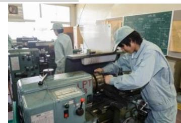
工作機械を使用し、鉄を削り加工する。
